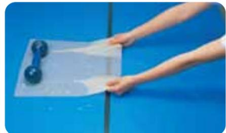
水分をたっぷり吸収させた状態の紙ウエスに3kgの鉄アレーを置き、ゆっくりと引っ張ります。すると、通常の紙ウエスは引き出した時点で破れ、鉄アレーは動きません(写真上)。パルパーの場合、鉄アレーを2倍の6kgをおいても破れず、非常に強度が高いのがわかります(写真下)。
