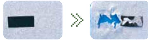
平面に広げたクロスに強力接着テープを貼り付け、ゆっくりとはがしてみると、同等の製品はクロスが破れてしまった。ラボクリーンは、少々繊維の剥がれが見えるものの、まったく破れは生じていない。
